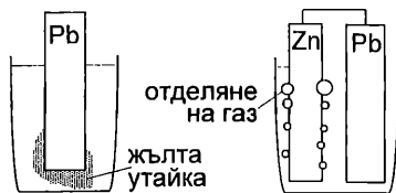
Фиг. 14. Протекторна защита на олово.
