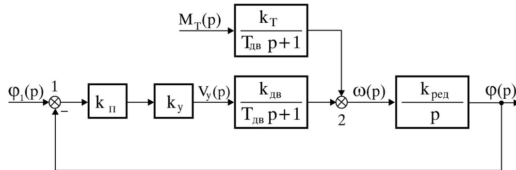
$$\omega(p) = \frac{k_{\partial\delta}}{T_{\partial\delta} p + 1} V_y(p) + \frac{k_T}{T_{\partial\delta} p + 1} M_T(p)$$
