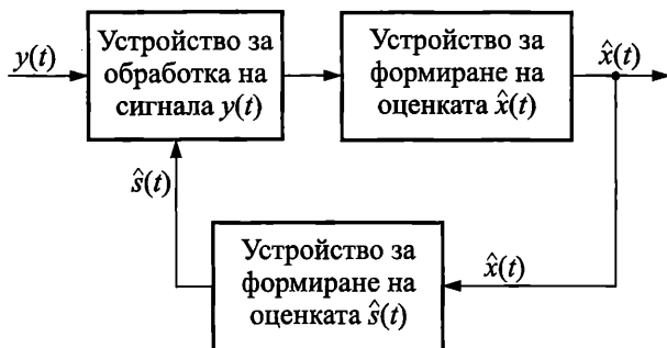
Опростена функционална схема на оптимален приемник
