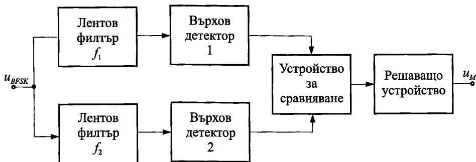
Демодулиране (детектиране) на сигнал с бинарна честотна манипулация - BFSK
