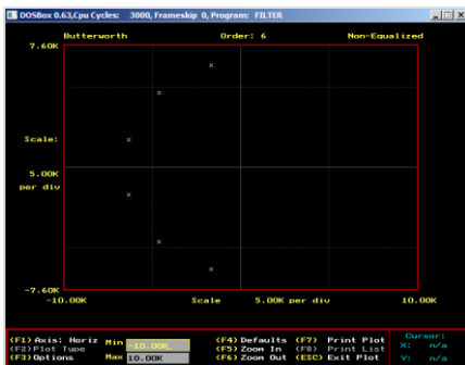
Фигура 22 Карта на полюсите и нулите по метода на Бътървурт
