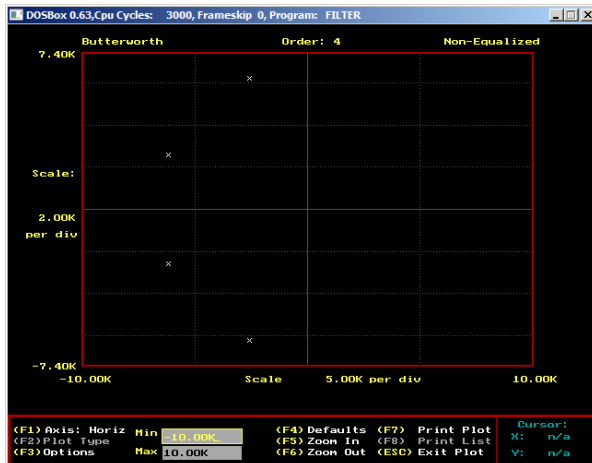
Фигура 4 Карта на полюсите и нулите при апроксимация на Бътървурт
