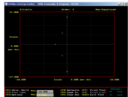
Фигура 24 Карта на полюсите и нулите по метода на Кауер
