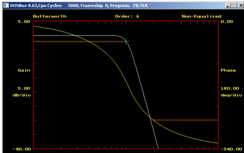
Фигура 17 АЧХ и ФЧХ по метода на Бътървурт
