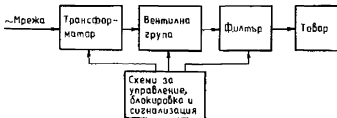
Фиг. 4.1. Схема на токоизправител
