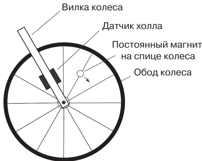
Рис. 4.46. Колесо велосипеда с датчиком Холла
