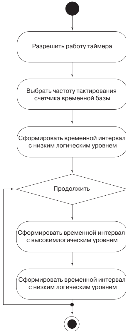
Рис. 4.44. Блок-схема алгоритма генерации импульсной последовательности с заданными временными параметрами
