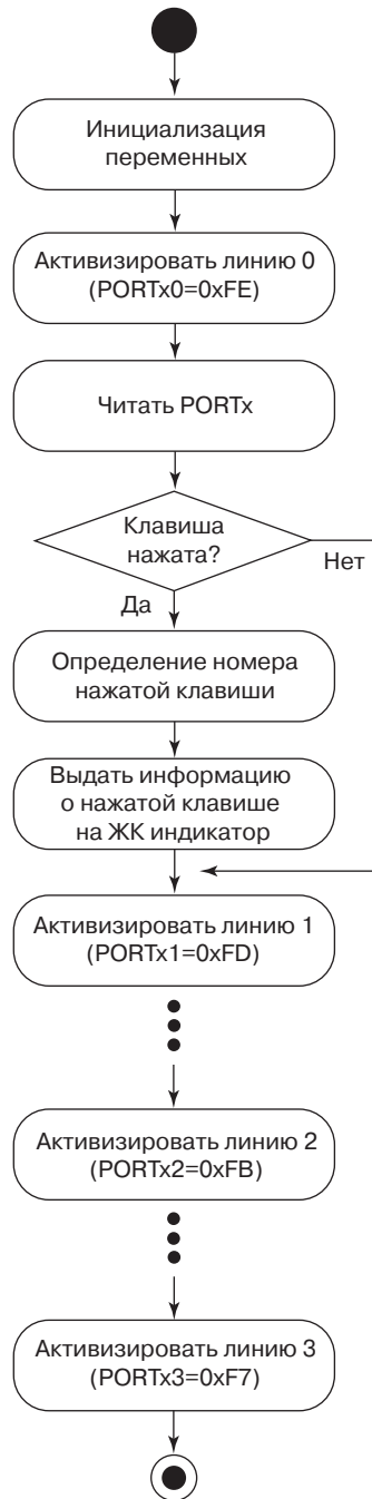
Рис. 5.6. Блок-схема алгоритма опроса матричной клавиатуры
