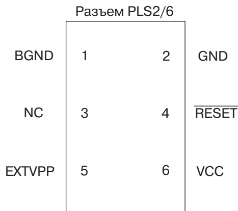
Рис. 3.5. Цоколевка разъема BDM порта
