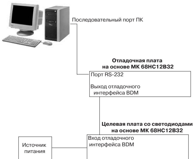
Рис. 3.9. Система отладки на основе двух отладочных плат с микроконтроллером 68HC12B32
