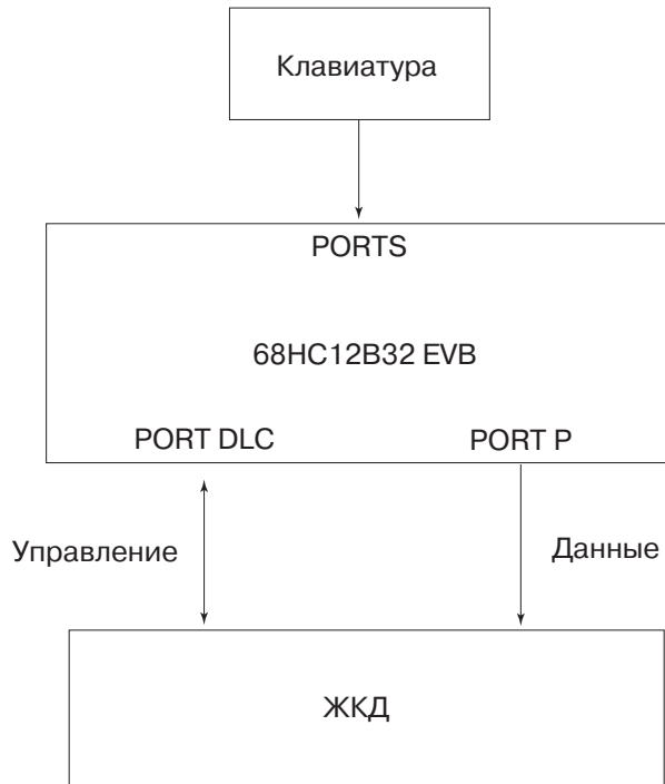
Рис. 7.38. Структура микропроцессорной системы для игры в «15»
