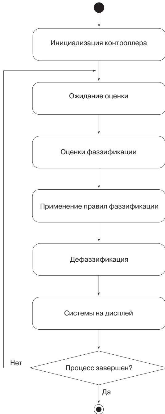
Рис. 7.30. Блок-схема алгоритма UML для системы защиты
