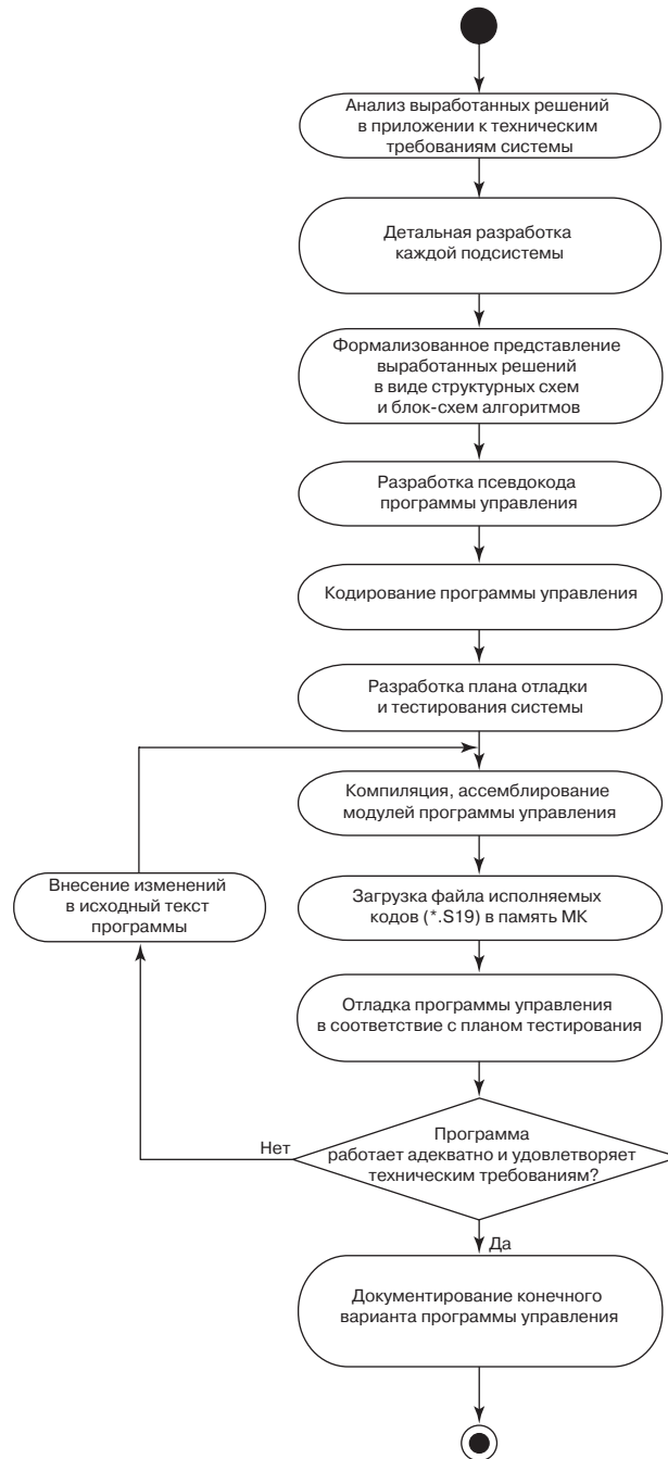
Рис. 2.8. Блок-схема алгоритма разработки и тестирования программного обеспечения встраиваемой системы
