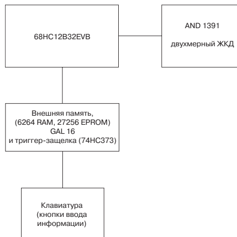
Рис. 7.37. Блок-диаграмма микропроцессорной системы для игры в «15»
