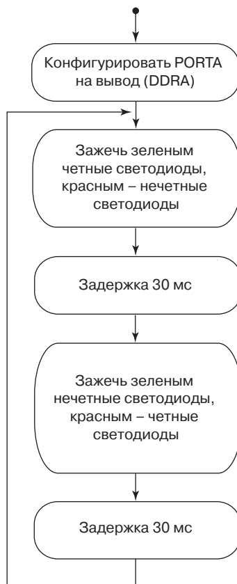
Рис. 4.10. Блок-схема алгоритма управления светодиодами
