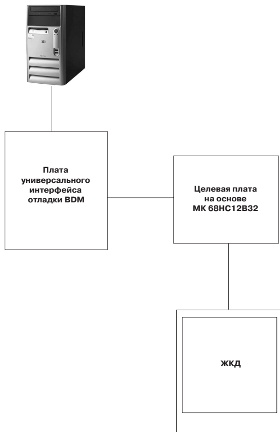
Рис. 7.29. Структура аппаратных средств системы защиты
