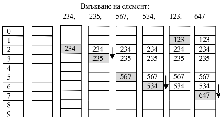
Фигура 2.4.2а. Последователно вмъкване на елемент. Разрешаване на колизиите с линеино пробване със стъпка 1.
