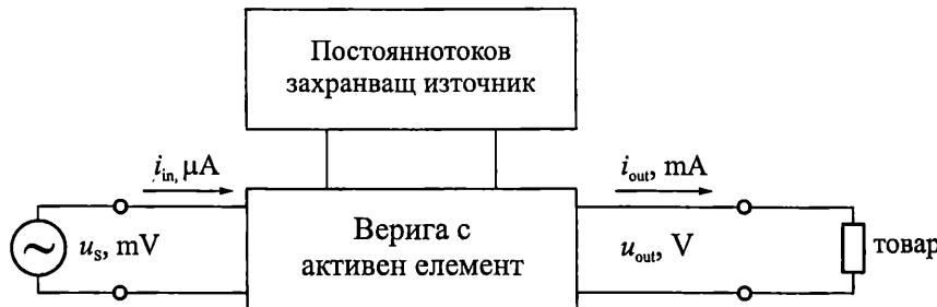
Фиг. 3.1. Функционална схема на усилвател на сигнали
