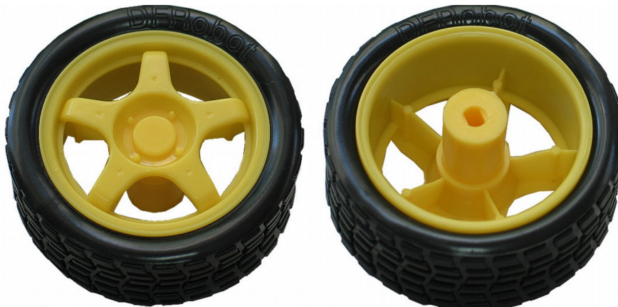
Фиг. 3.5 Гуми, използвани за задвижване на мобилната система за наблюдение
