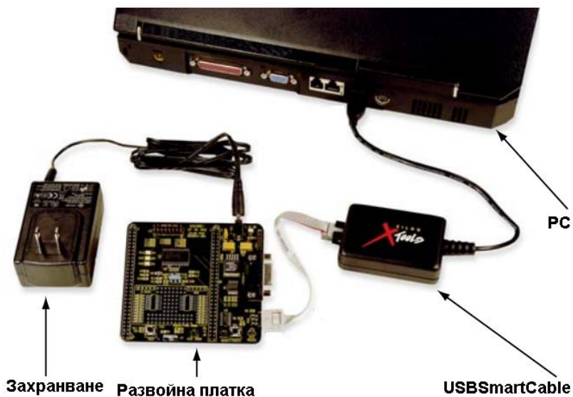
Фиг. 235 Свързване на дебъгера към платката и компютъра
