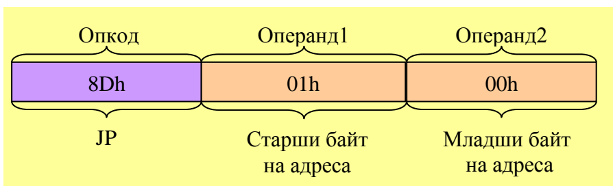
Фиг. 194 Структура на инструкцията JP 0100h
