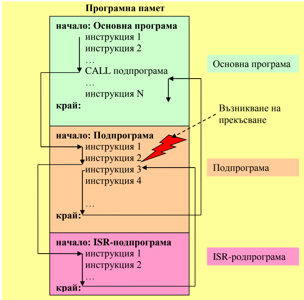
Фиг. 110 Конструкция и изпълнение на програма
