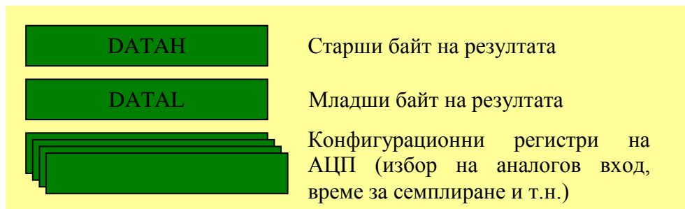
Фиг. 148 Програмен модел на АЦП модул
