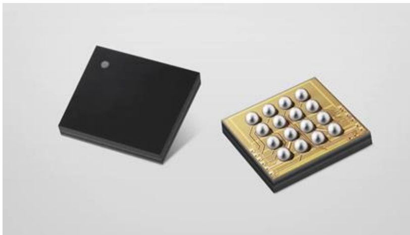
Интегрални схеми (ИС) с изводи непосредствено от подложката: WLCSP - Wafer Level Chip Scale Package
