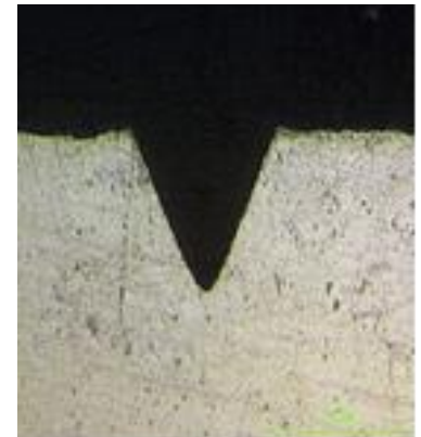
Резка, останала на повърхността на подложката след скрайбирание.
