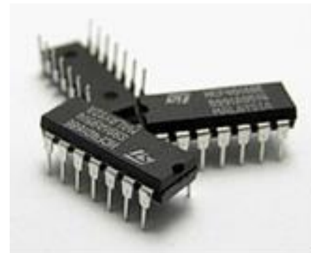
Схема на монтиране в пластмасов корпус и херметизирана интегрална схема
