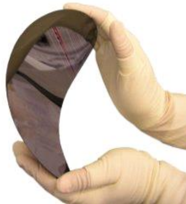
Изтънена силициева пластина – гъвкава след ецването.
