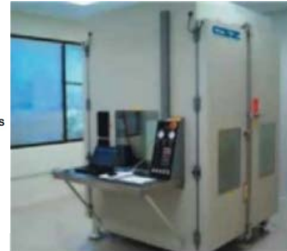
Камера за провеждане на HALT & HASS
