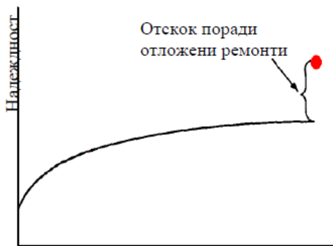
Фиг. 7. Test-Fix-Test с отложени ремонти
