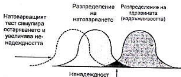
Фигура 4.1. Принцип на ускорения тест
