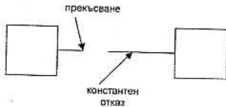
Фиг. 8.2. Константен отказ причинен от прекъсване
