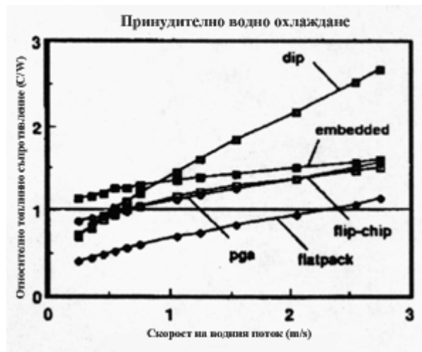
фиг.7 Относително топлинно съпротивление спрямо на некорпусирания чип, при принудително водно охлаждане
