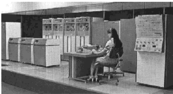
Система „ЕС 1022 В“ (централен процесор и външни запамятаващи устройства на магнитен диск и на магнитна лента)
