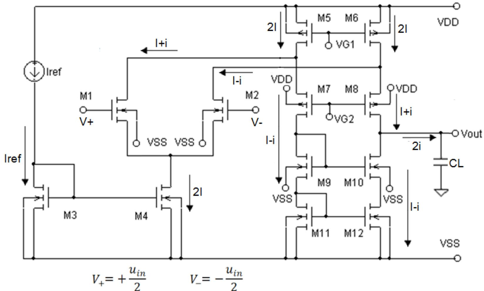
Оразмерете схемата за  $GBW=f_u=5\text{MHz}$  при  $CL=5\text{pF}$ .
