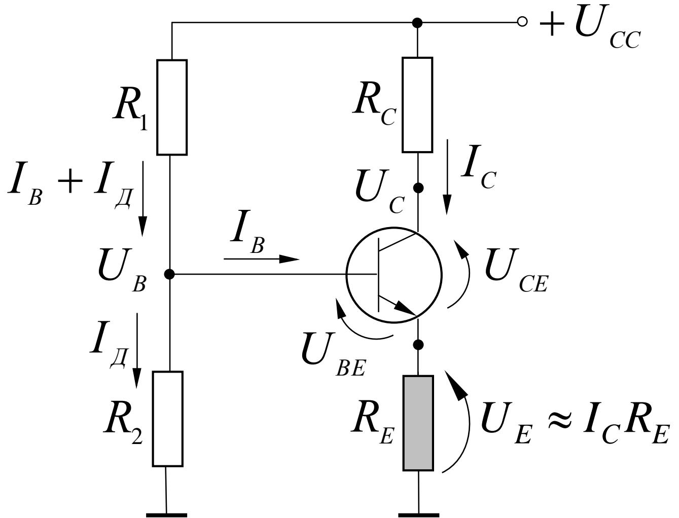
При условие, че  $I_D \gg I_B$ ,  $I_D \approx \frac{U_{CC}}{R_1 + R_2}$  или
