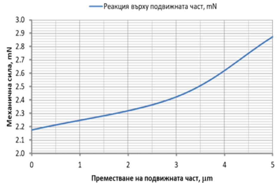
МЕХАНИЧНА СИЛА СПРЯМО ПРЕМЕСТВАНЕ НА ПОДВИЖНАТА ЧАСТ
