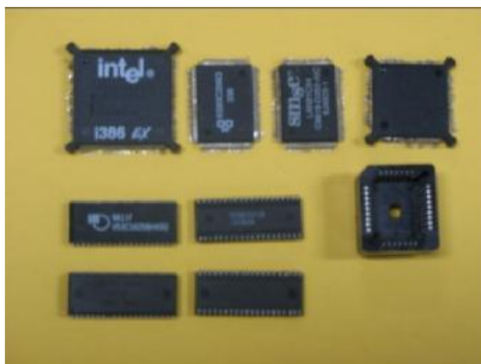
Фиг.4. Корпуси на интегрални схеми за повърхностен монтаж
