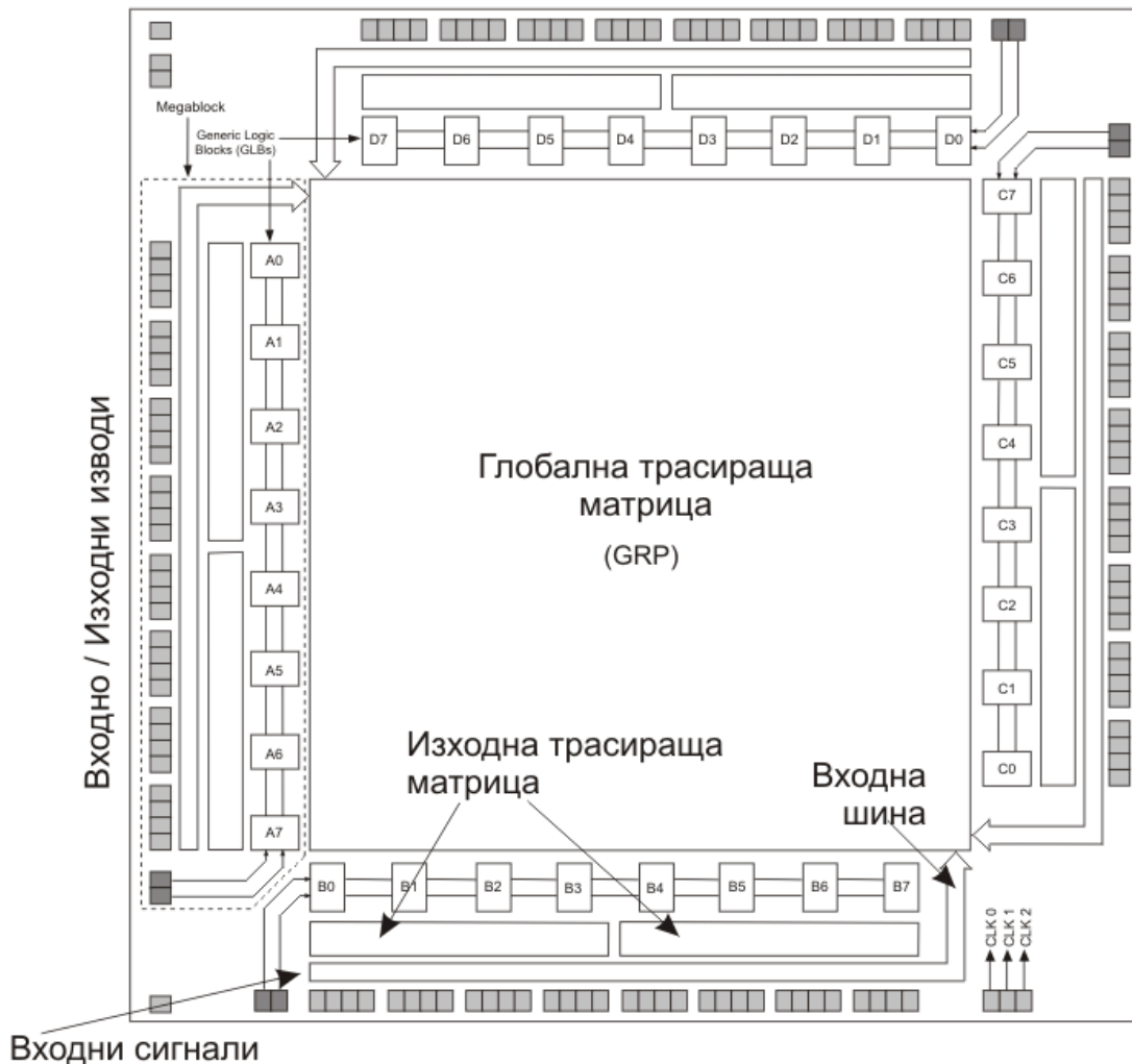
Фиг. 5.11. Архитектура на фамилията pLSI и ispLSI
