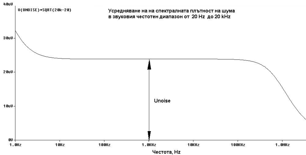
Фиг. 3. Определяне на шумовото напрежение чрез усредняване в зададен честотен диапазон
