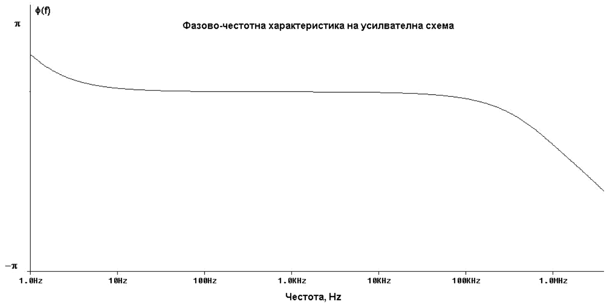
Фиг. 6. ФЧХ на усилвателна схема
