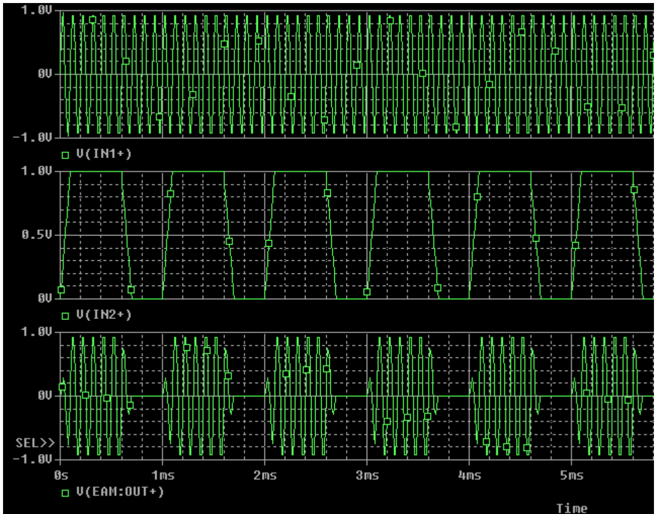
Фиг.13. Резултати от симулацията на амплитудно-модулиран сигнал
