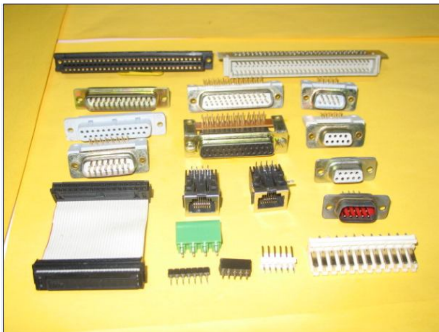
Фиг. 6. Съединители за нормален монтаж
